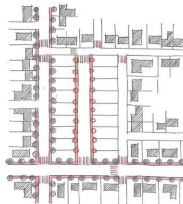
A proscrire Liaison douce le long d'une rue hors d'échelle. Absence de convivialité
