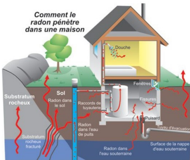
Propagation du radon dans une habitation
